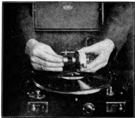
De slijtage der platen hangt af van den naaldstand. Zorgt voor den juistten stand van den opnemer.
